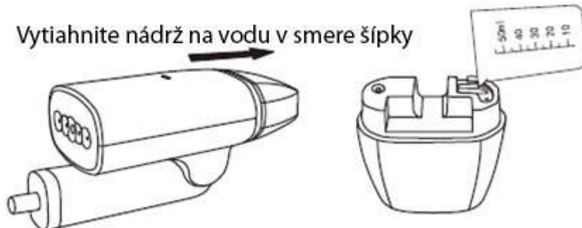
Demontáž nádrže na vodu
