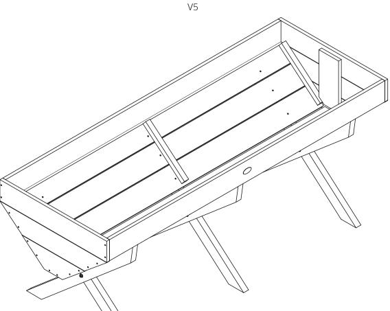
$(W \times D \times H)$ : 2.0m  $\times$  0.75m  $\times$  0.80m
